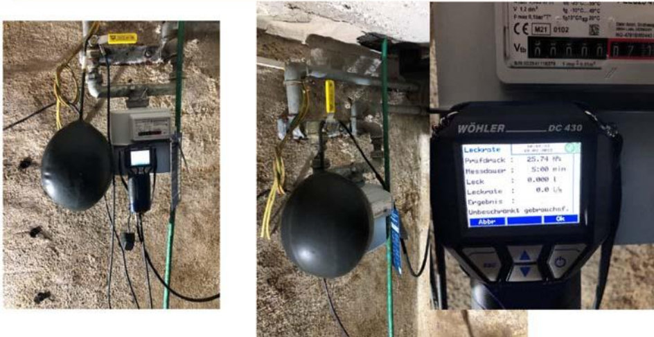
Bild – Messaufbau für Leckmengenmessung mit Messgerät
